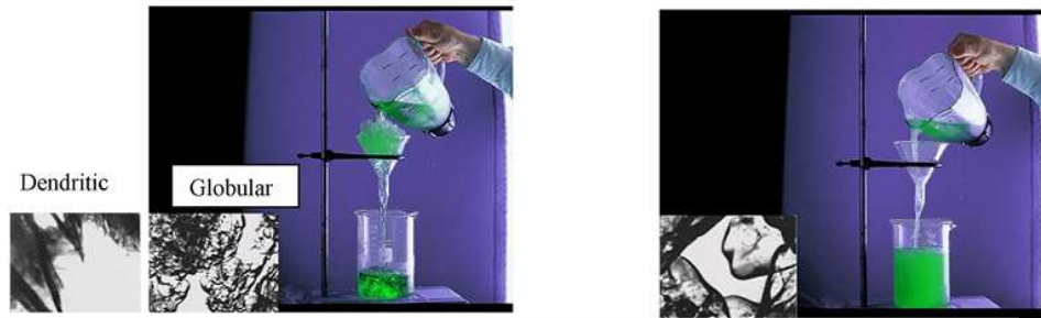
Gambar 2. 1 (a) Tak mampu lolos pada penyaring; ice slurry yang buruk. (b) Mampu lolos pada penyaring; ice slurry yang baik.
