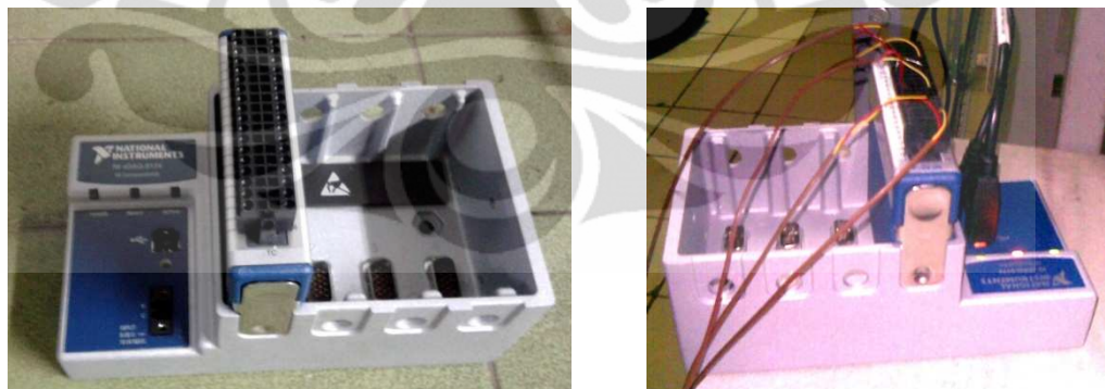
Gambar 3.12 Data akuisisi yang digunakan, yaitu DAQ produksi National Instrument .
