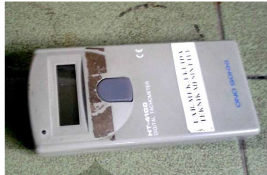
Gambar 3. 16 Tachometer yang digunakan untuk mengukur putaran motor.
