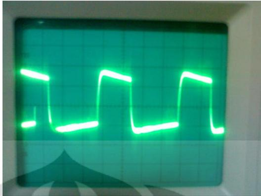
Gambar 4.15. Gelombang output rangkaian *prototipe* inverter saat beban 220 ohm
