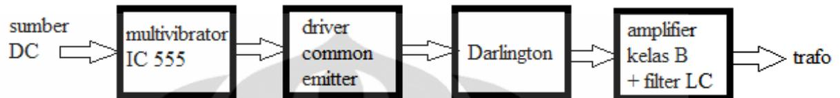
Gambar 4.13. Diagram alir model prototipe inverter menurut *schematic* gambar 4.4
