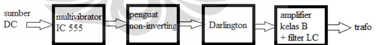
Gambar 3.1. Diagram alir inverter
