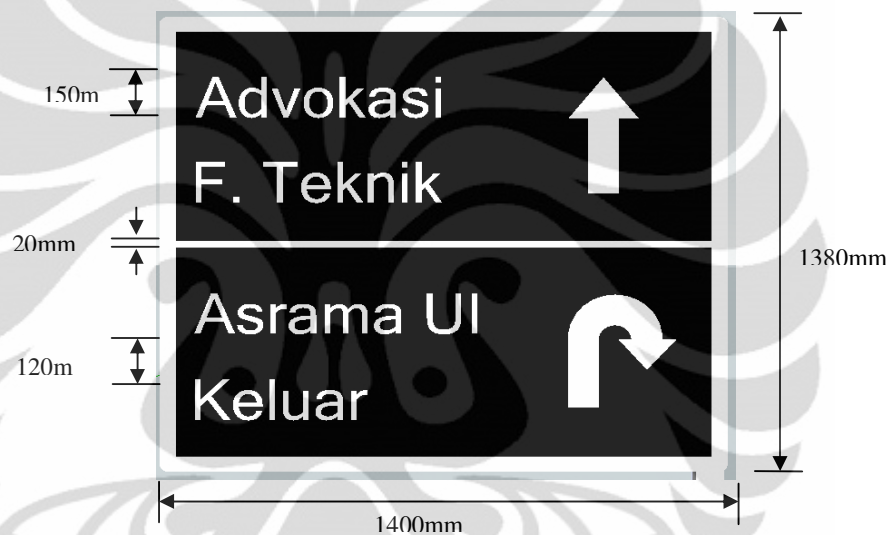
Gambar 3. 9 Ukuran Papan yang Digunakan (dalam mm)
