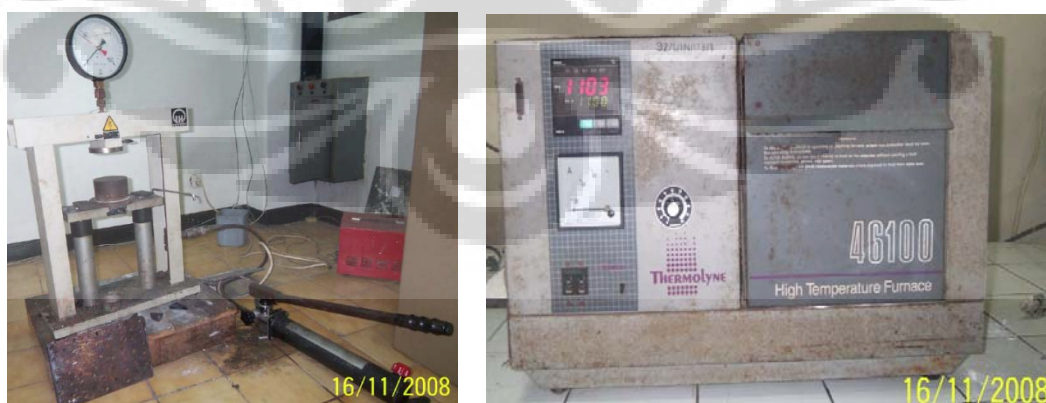
Gambar 3.4. Alat Kompaksi dan alat pemanas High Temperature Furnace
