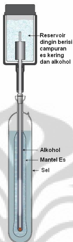
Gambar 18. Proses pembuatan mantel es pada titik tripel air
