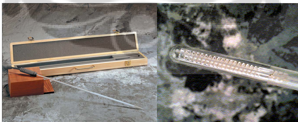
Gambar 11. SPRT model 568X (kiri) berikut bentuk sensor Pt-2,5 dan Pt-25 (kanan) buatan Hart Scientific
