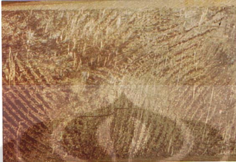
Gambar 4.5.2.16 Sampel pendinginan udara – waktu celup 72 jam – perbesaran 7x
