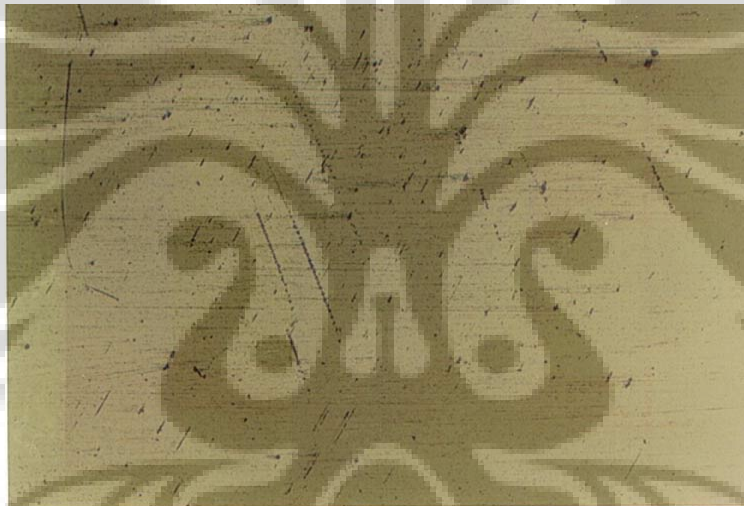
Gambar 4.5.2.26 Sampel pendinginan air – waktu celup 72 jam – perbesaran 100x
