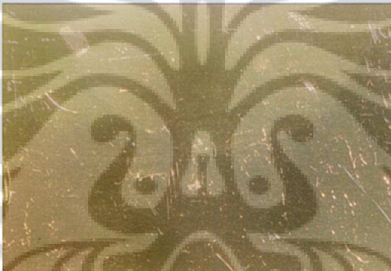
Gambar 4.5.2.17 Sampel pendinginan air – waktu celup 72 jam – perbesaran 7x
