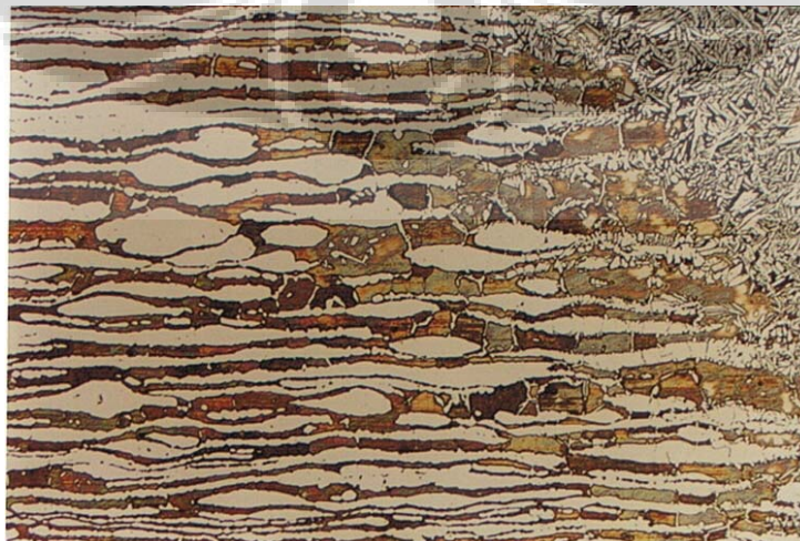
Gambar 4.2.5.2 Foto struktur mikro daerah HAZ sample pendinginan air perbesaran 100x
