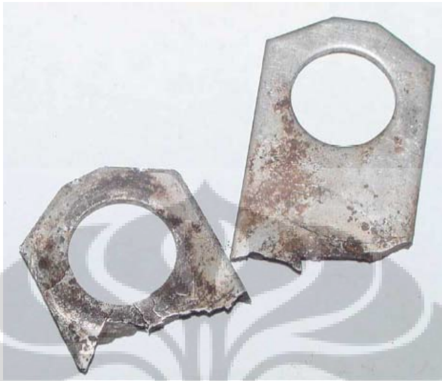
Gambar 2.4.10 Contoh bentuk stress corrosion cracking pada sebuah pompa yang bekerja 55 pada lingkungan klorit
