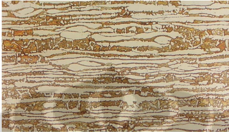
Gambar 4.2.6.1 Foto struktur mikro daerah base metal sample pendinginan udara perbesaran 100x
