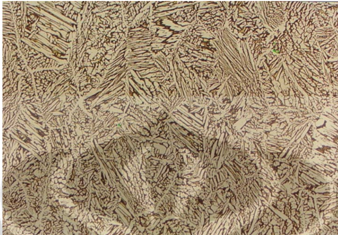
Gambar 4.2.4.1 Foto struktur mikro daerah lasan sample pendinginan udara perbesaran 100x
