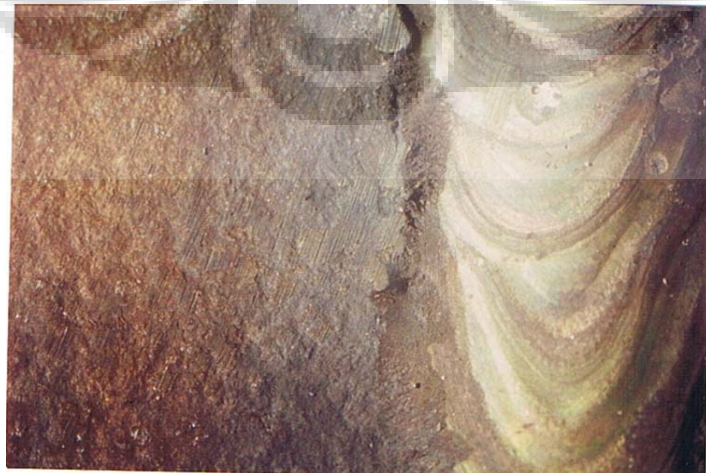
Gambar 4.2.2.2 Foto makro daerah HAZ sample pendinginan air perbesaran 7x
