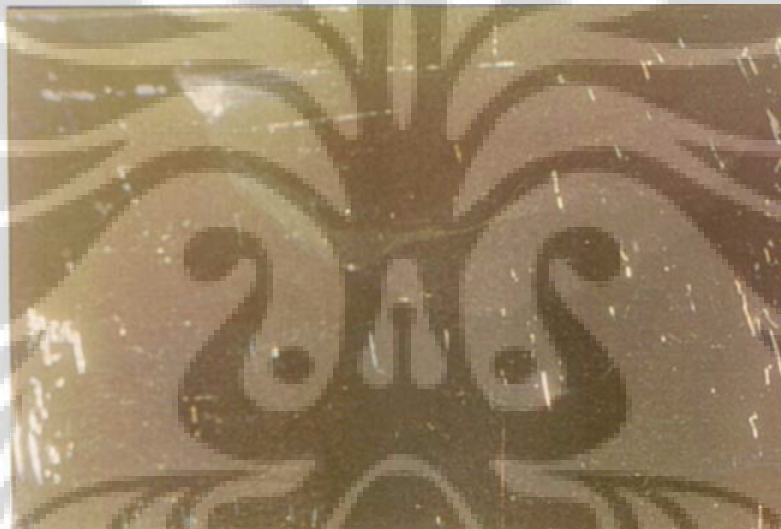
Gambar 4.5.2.14 Sampel pendinginan air – waktu celup 48 jam – perbesaran 7x
