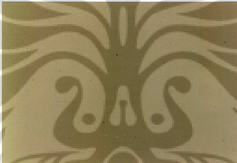
Gambar 4.5.2.29 Sampel pendinginan air – waktu celup 24 jam – perbesaran 100x
