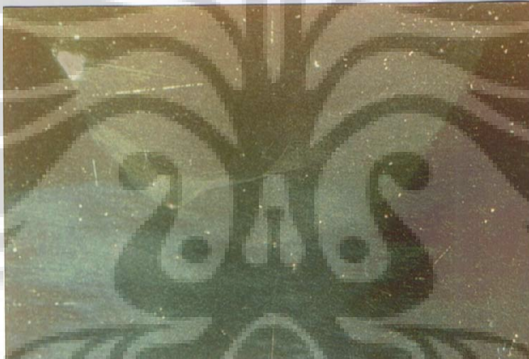
Gambar 4.5.2.11 Sampel pendinginan air – waktu celup 24 jam – perbesaran 7x
