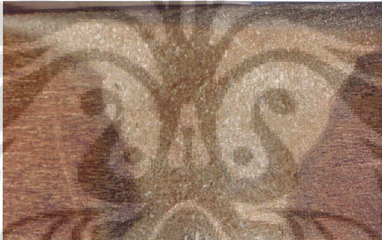
Gambar 4.2.3.2 Foto makro penampang melintang sample pendingin air perbesaran 7x
