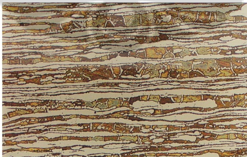
Gambar 4.2.6.2 Foto struktur mikro daerah base metal sample pendinginan air perbesaran 100x
