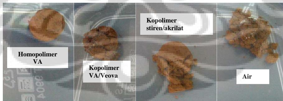
**Gambar 4.8** Kondisi spesimen setelah direndam lebih dari 18 jam
