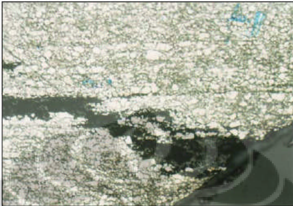
Gambar 5.6. Foto Mikrostruktur (Perbesaran 100x) kegagalan yang terjadi pada material U Bent-Tube
