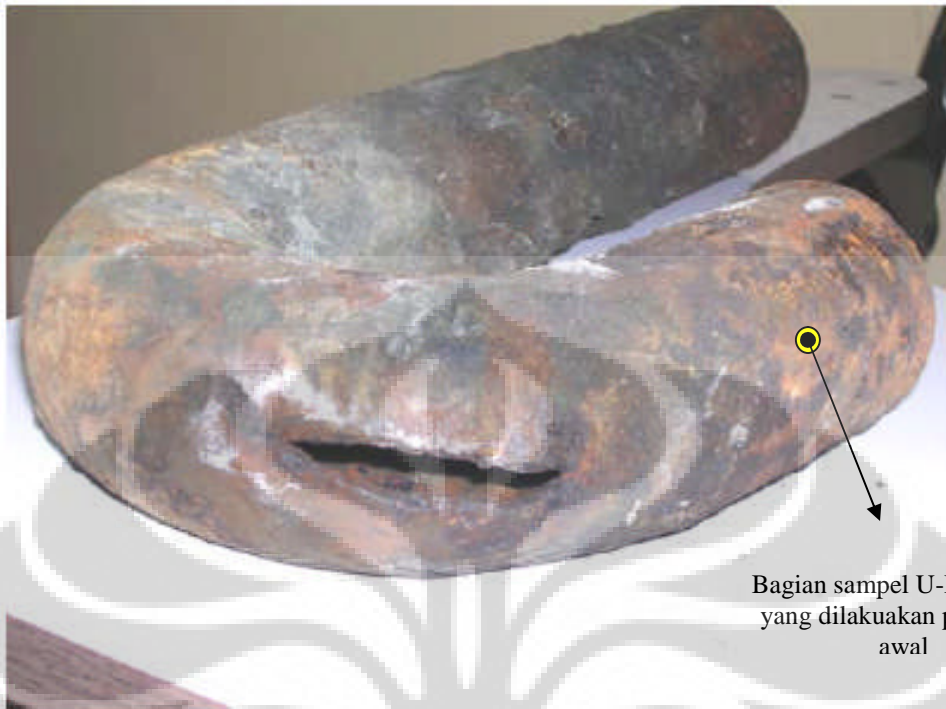
Gambar 4.2. U Bent-Tube yang mengalami kegagalan
