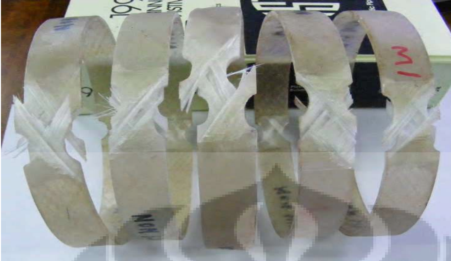
Gambar 5.3 Spesimen hasil uji tarik hoop pipa non silika
