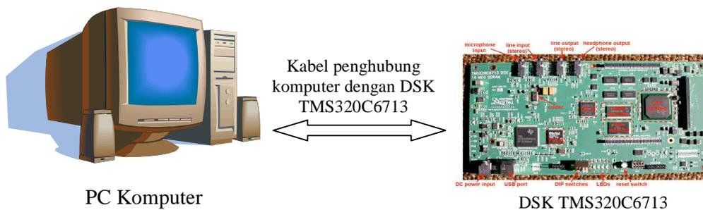
Gambar 3.2 Konfigurasi hubungan PC Komputer dengan DSK TMS320C6713
