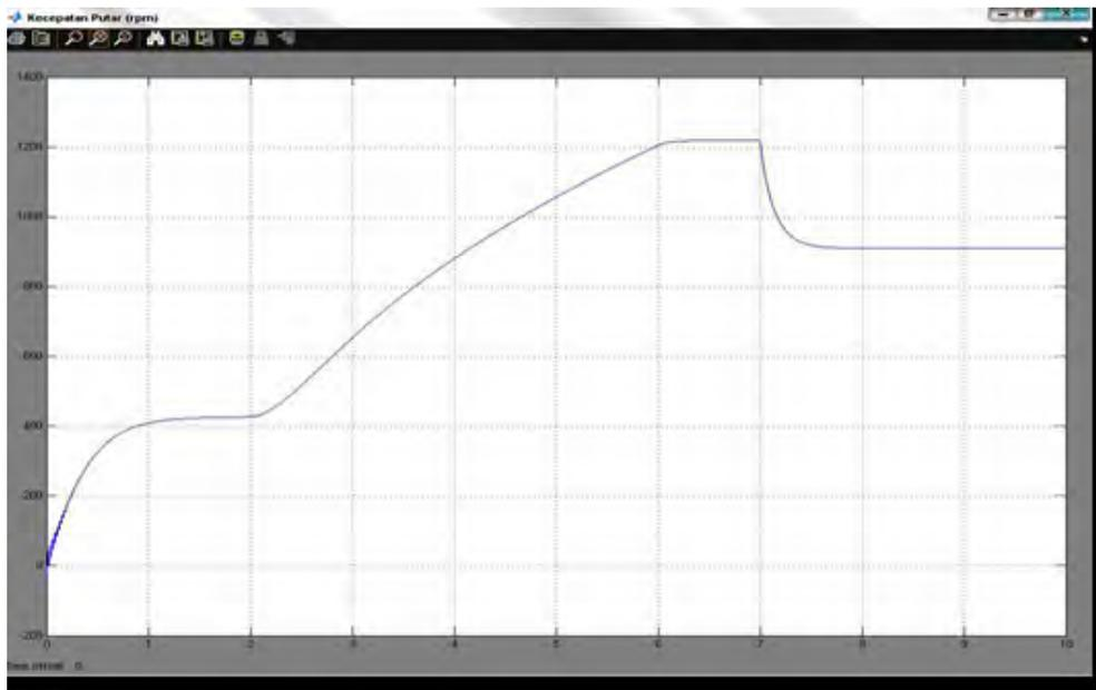
Gambar 4.1. Grafik kecepatan putar motor induksi tiga fasa
