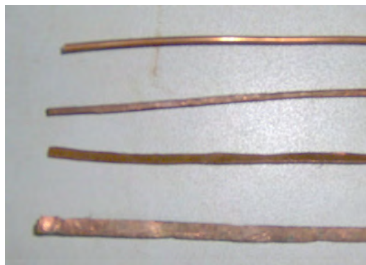
Gambar 4.2 Sampel uji berturut-turut dari atas adalah penghantar dengan penampang bentuk I, II, III, IV
