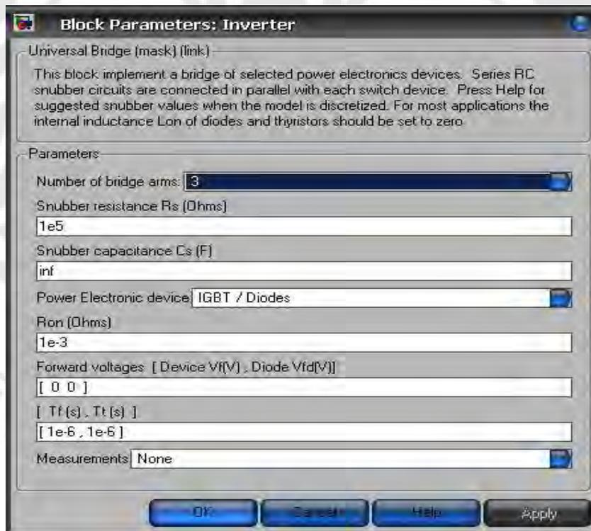
Gambar 3. 7. Blok parameter model *universal bridge* MATLAB untuk inverter
