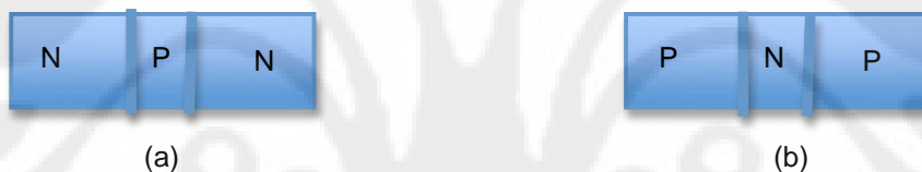
Gambar 2. 7 (a) Konfigurasi BJT tipe NPN; (b) Konfigurasi BJT tipe PNP
