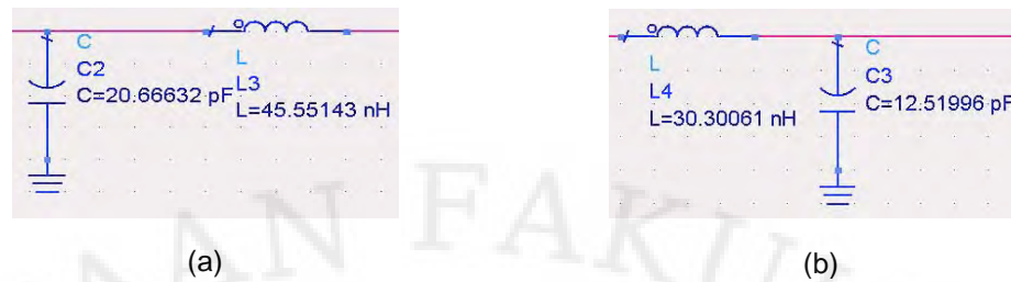
Gambar 3. 5 (a) Rangkaian impedance input matching; (b) Rangkaian impedance output matching
