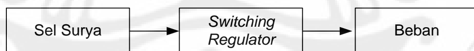
Gambar 3.1 Blok diagram implementasi switching regulator untuk komputer bergerak dengan menggunakan panel surya
