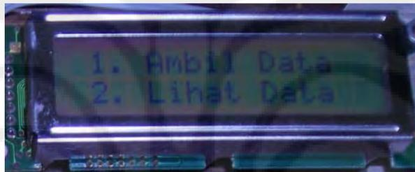
**Gambar 4.6** Tampilan LCD pada rangkaian Control.
