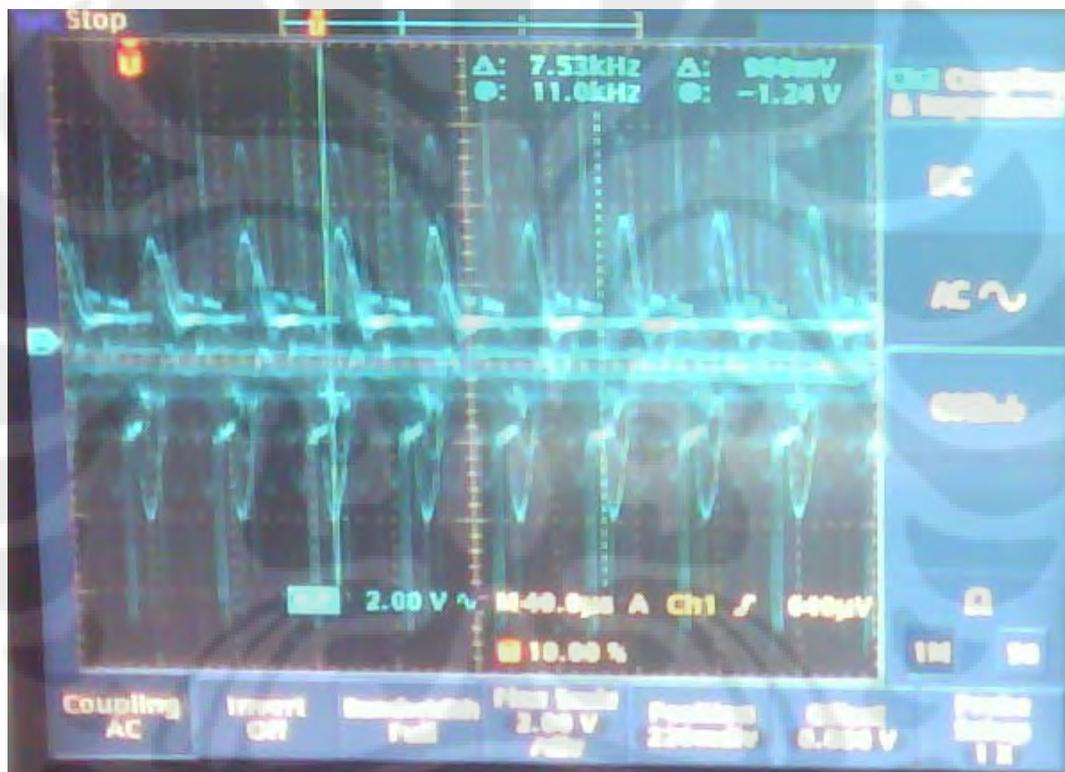
Gambar 4.2 Gelombang Sinusoidal Antar Fasa
