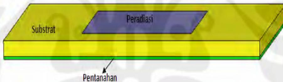
Gambar 2.1. Struktur Dasar Antena Mikrostrip
