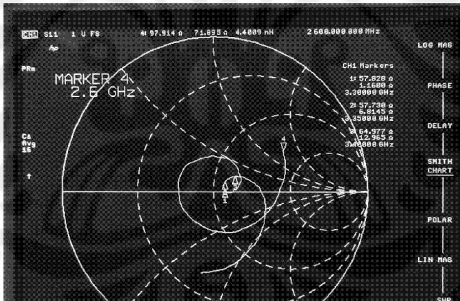
Gambar 4.53 Grafik Impedansi Masukan Hasil Pengukuran Antena *Array* 2 Elemen
