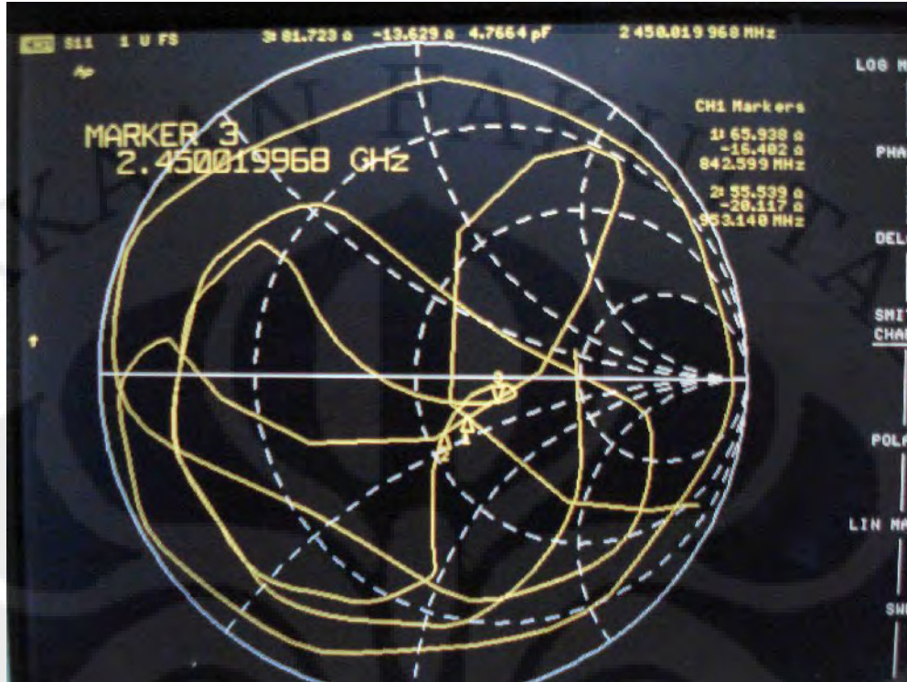
Gambar 4.9 Smith Chart Pengukuran Antena
