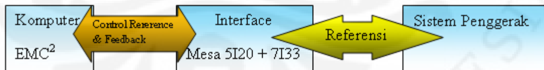
Gambar 3.26 Blok diagram pengendali dengan EMC 2
