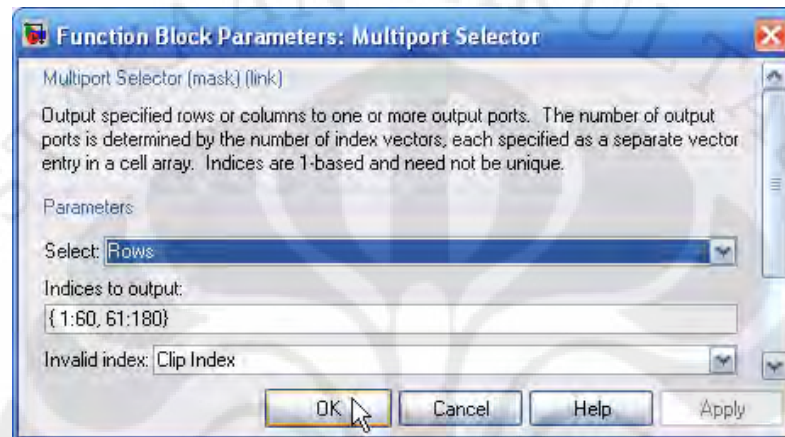
Gambar 3.6 Pengaturan parameter blok Multiport Selector
