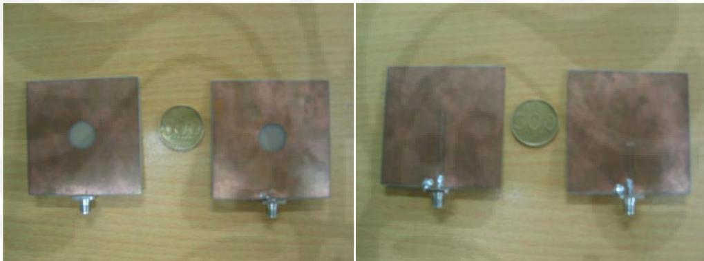
Gambar 4.1 Antena dengan frekuensi kerja 2,3 – 2,4 GHz
