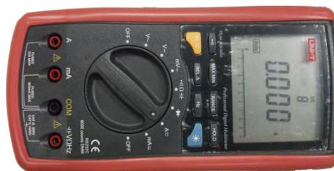
Gambar 3.4 Amperemeter dan voltmeter
