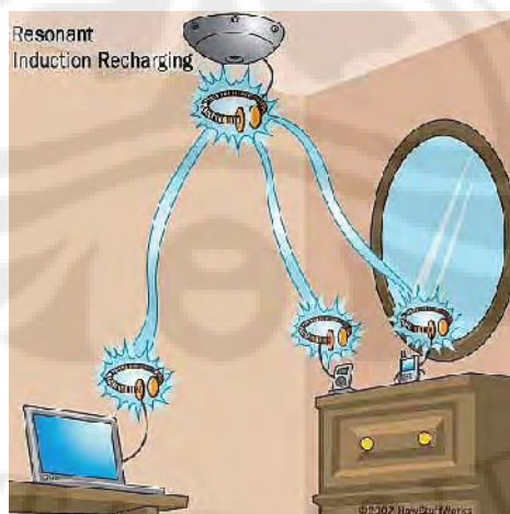
Gambar. 1.1 Pemancar daya listrik yang digunakan sebagai sumber daya alat-alat elektronik di sekitarnya [7][8] .
