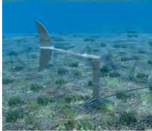
Gambar 2.6 Sirip Ikan hiu buatan yang disebut biostream hasil ciptaan Prof. Tim Finnigan dari Departemen Teknik Kelautan, University of Sydney [7]
