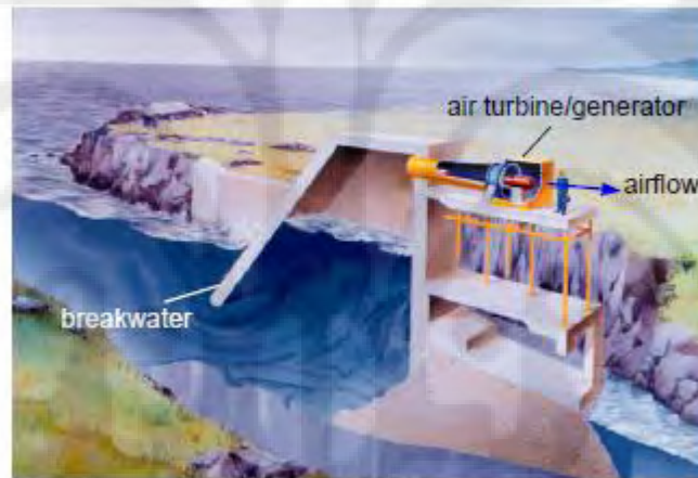
Gambar 2.2 Energi kinetik yang terdapat pada gelombang laut digunakan untuk menggerakkan turbin [3]
