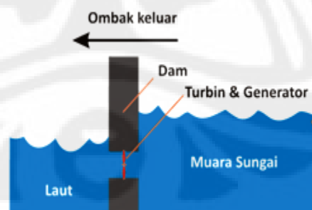
Gambar 2.10 Ketika surut, air mengalir keluar dari dam menuju laut sambil memutar turbin [6]
