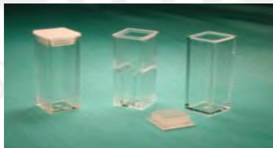
Gambar 2.10. Sel tempat sampel (cuvette/kuvet)
