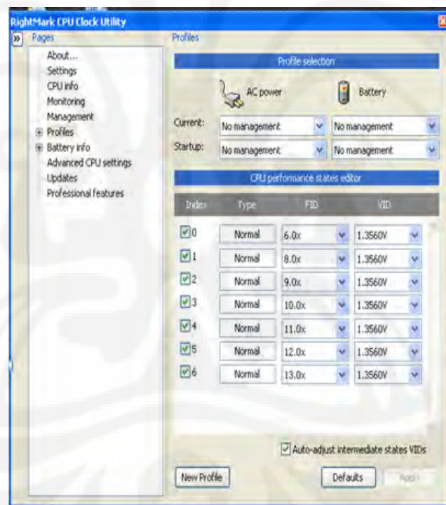
Gambar 3.16 Pengaturan tegangan CPU
