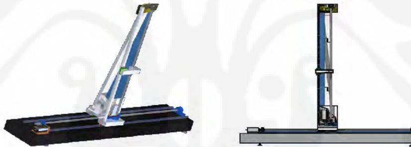
Gambar 3.7 Antena positioner untuk pengukuran medan dekat
