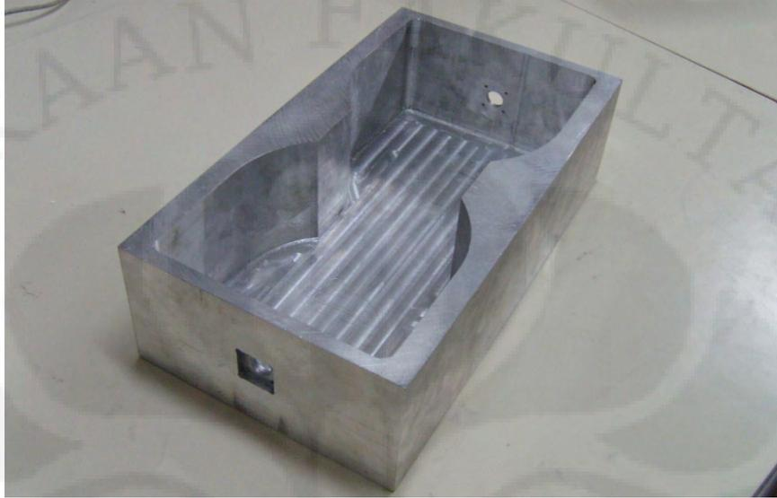
Gambar 4.5 Alumunium setelah di bubut
