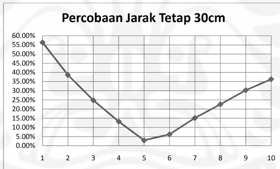
Gambar 4.4. Grafik Hubungan Kapasitor dan \Delta f_r Pada Percobaan Jarak Tetap 30cm
