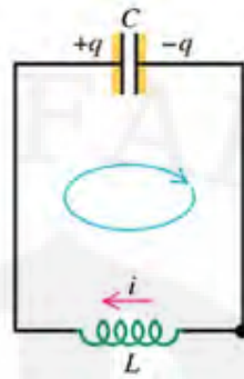
Gambar 2.16. Skematik Analisa Noda Rangkaian LC [5]
