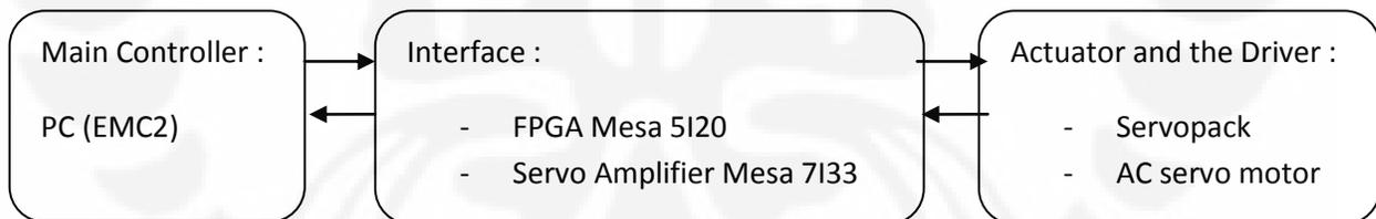
Gambar 2.2 diagram blok rancangan mesin CNC
