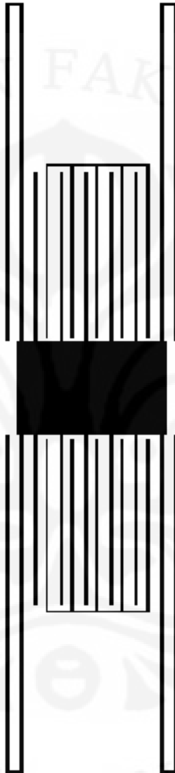
Gambar 3.1. Bentuk umum desain MEMS akselerometer kapasitif yang disimulasikan
