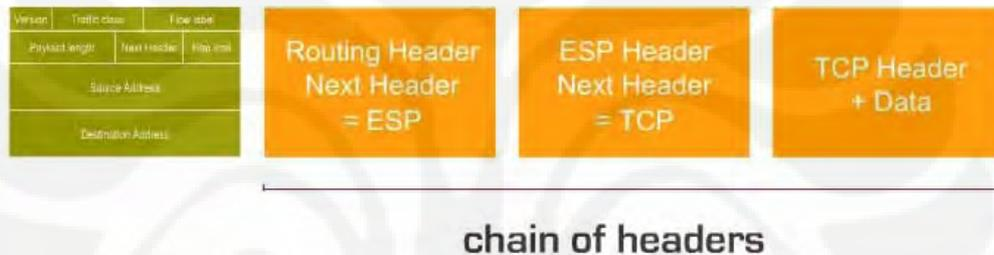
Gambar 2.4. Struktur IPv6 dengan *Extension Header* [3]
