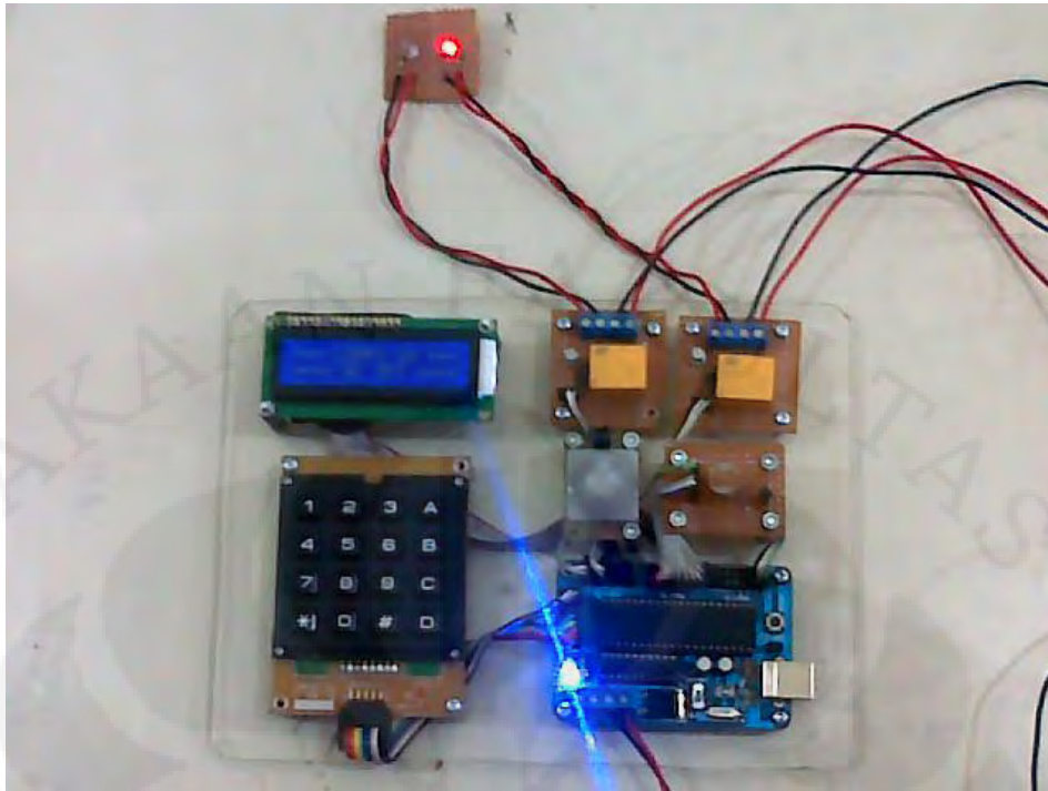
Gambar 4.8 – Tampilan Sistem Ketika Lampu Hidup dan Pendingin Ruangan Mati
