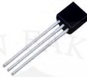
Gambar 2.5 – Sensor Suhu LM35 (bentuk TO-92)
