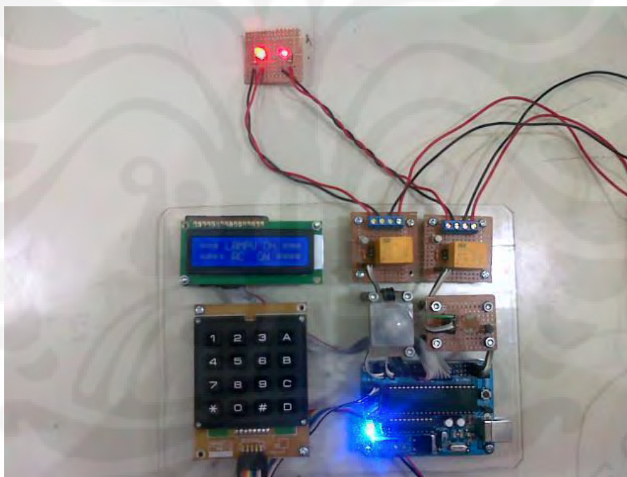
Gambar 4.10 – Tampilan Sistem Ketika Lampu Hidup dan Pendingin Ruangan Hidup
