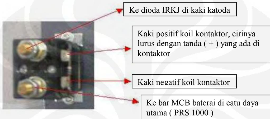
**Gambar 3.12** Konfigurasi kontaktor pada sistem DLVBD
