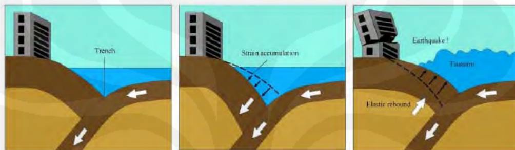
Gambar 2.5 Pergerakan lempeng bumi pada daerah patahan yang akan menimbulkan deformasi dasar laut secara vertikal yang akan menyebabkan timbulnya gelombang tsunami.[5]
