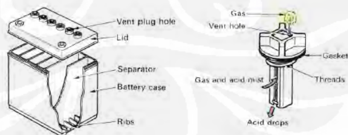
Gambar 2. 14Penampang baterai dan sumbat ventilasi
