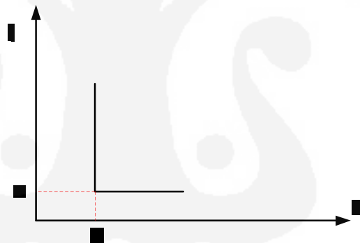
Gambar 2.10.Karakteristik waktu tertentu (waktu – arus)
