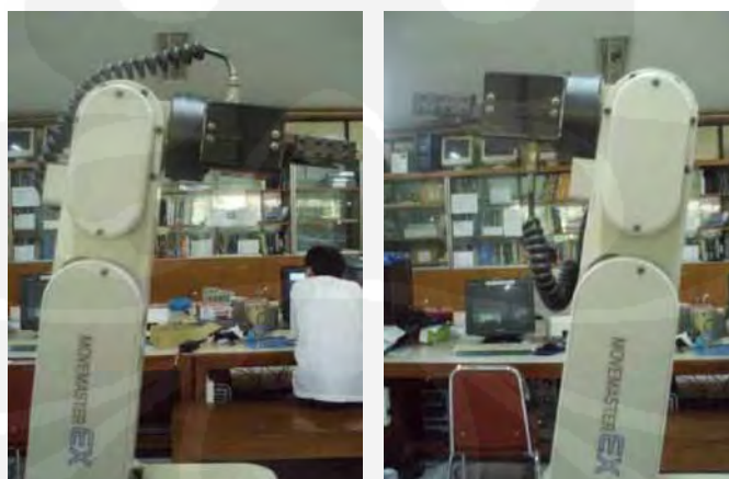
Gambar 4.19 Pergerakan manual joint 4 hasil pengujian
