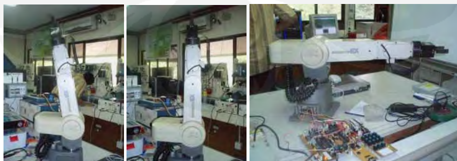
Gambar 4.9 Pergerakan manual joint 2 hasil pengujian
