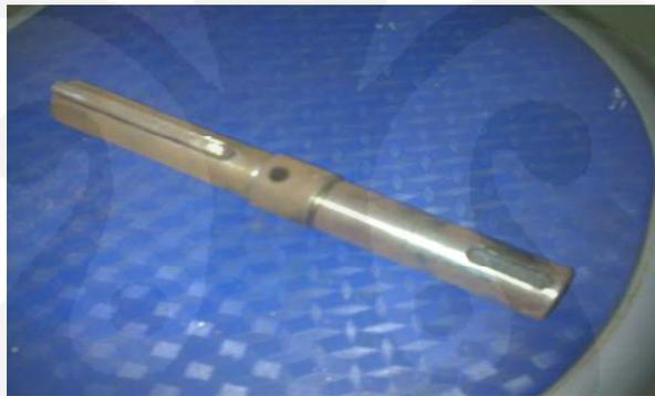
Gambar 3.6 Batang as untuk *gear* penggerak melalui proses pembubutan
