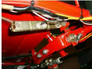
Gambar 3.17 Hasil perakitan potensiometer pada rangka mobil listrik
