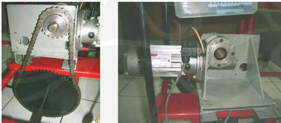
Gambar 3.15 Hasil perakitan perangkat mekanik mobil listrik
