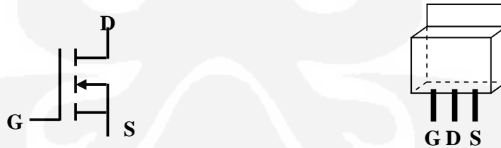
Gambar 2.15 Simbol dan bentuk Mosfet tipe N
