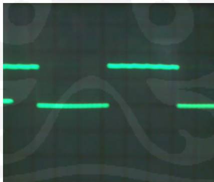
Gambar 4.3 Hasil pengukuran sinyal pada pengendali inverter bridge mosfet
