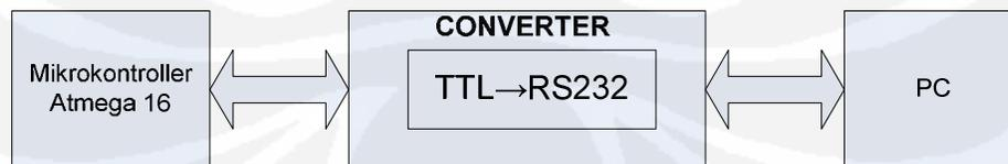
Gambar 3.8 Blok Komunikasi Antara Mikrokontroler Dengan PC
