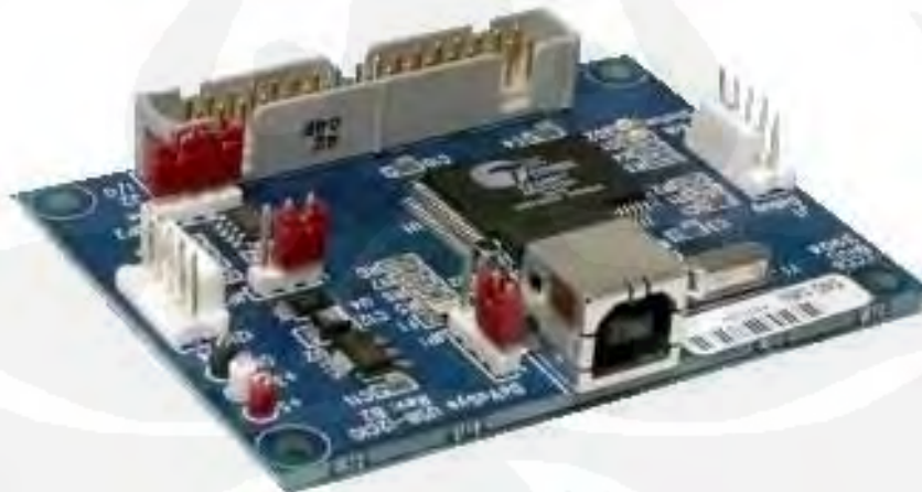
Gambar 2.3. Modul Antarmuka USB Devasys I2C/IO. [4]
