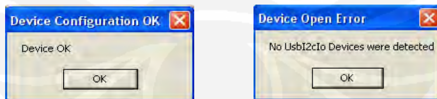
Gambar 4.1. Indikator yang menunjukkan berhasil atau tidaknya modul interface USB Devasys I2C I/O dikenali oleh PC
