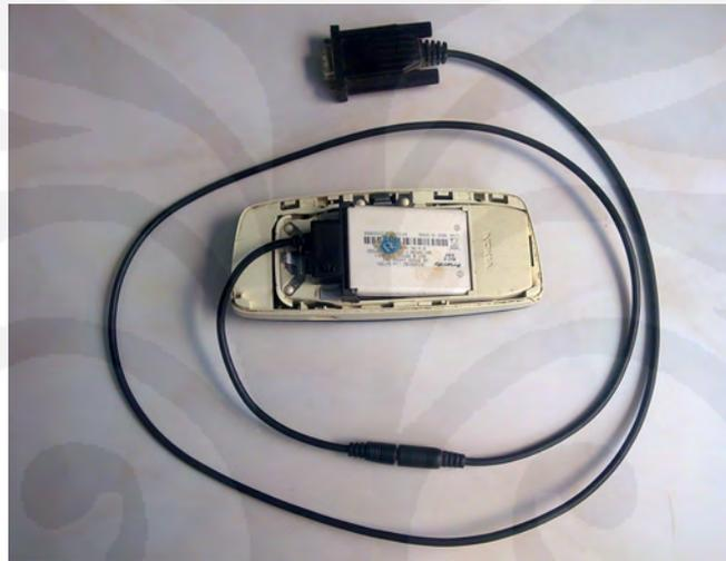
Gambar 4.24 Pemasangan kabel data Nok-2 pada *handphone* Nokia 5510
