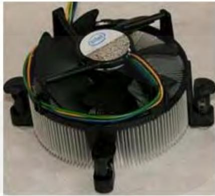
Gambar 2.6 *Heatsink* untuk mikroprosesor Intel Core i7 920 *Bloomfield*
