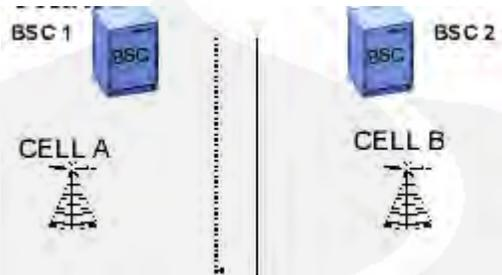
Gambar 3.14.  $A \rightarrow B$  offset = -5dB tidak ada offset  $B \rightarrow A$
