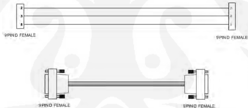
Gambar 3.2 Pin dan Perkabelan RS232 Remote Modem[5]
