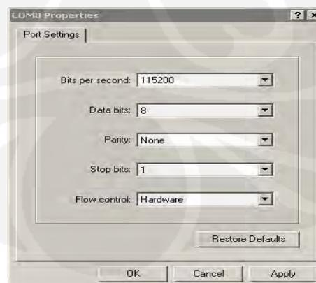
Gambar 2.3 Setting Koneksi Pada HyperTerminal
