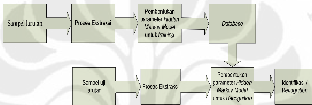
Gambar 3.21 Blok diagram Identifikasi kadar melamin pada makanan dengan metode Hidden Markov Model
